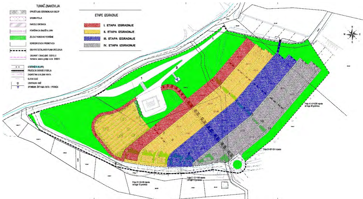
Slika 1.1.-1. Prikaz etape izgradnje zahvata
